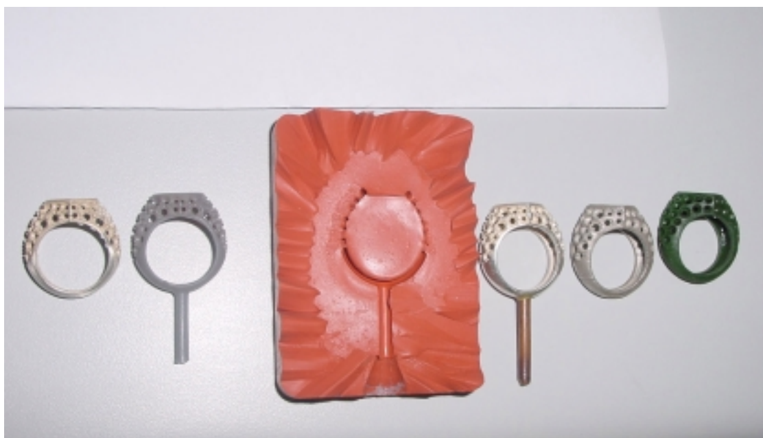
Imagem 4 – Seqüência de protótipos construídos em cera e fundido em prata
