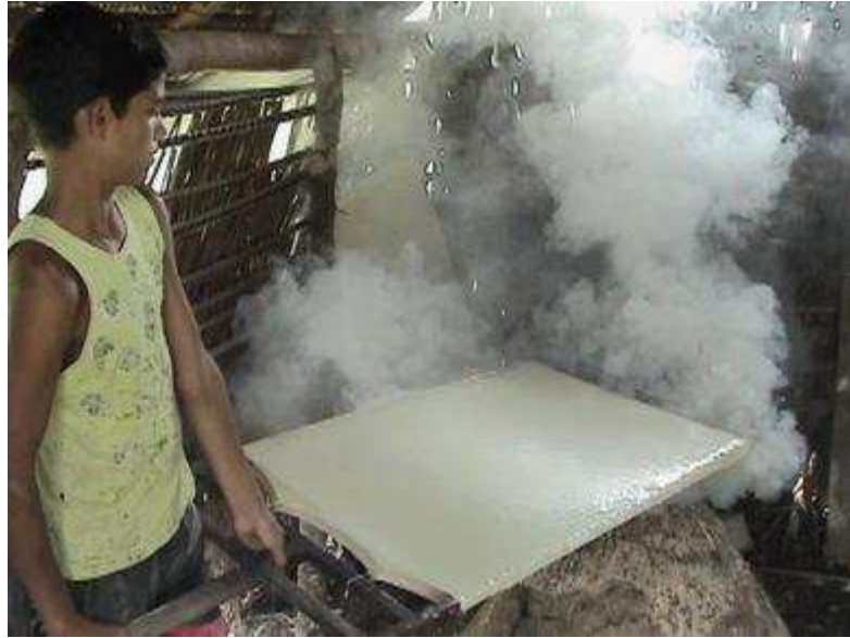
Figura 9: Preparação do tecido trabalhado com látex – etapa de defumagem
