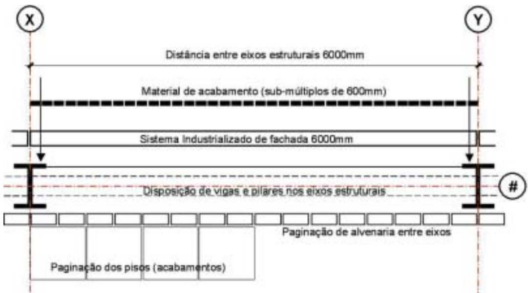
Figura 12- Parâmetros de coordenação modular entre sistemas (Silva, 2004)
